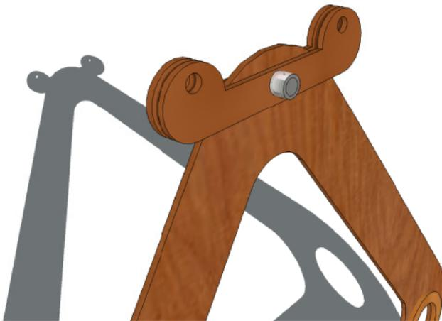
Als nächstes werden die Waagebalken ausgesägt und gebohrt. Es handelt sich um die 4 Teile mit der Bezeichnung C auf dem Blatt 3 des Bauplanes.
