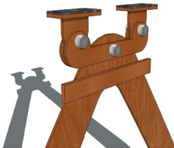
Die Abstandshalter K werden mittig an der Unterkante des oberen Ständerbogens mit Weißleim angebracht. Es ist darauf zu achten, dass die Abstandshalter parallel zur Unterkante des Ständers angeklebt werden.
