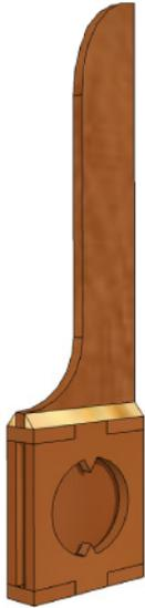
Die Anschlagoberteile G werden laut Plan Blatt 6 ausgesägt und mittig senkrecht auf die Anschlagläufer montiert. Zur Stabilisierung werden an den Kanten zwischen Anschlagoberteilen und Anschlagläufern 2mm starke Kiefernholzleisten angeklebt. Auch hierzu wird wieder Weißleim verwendet.
